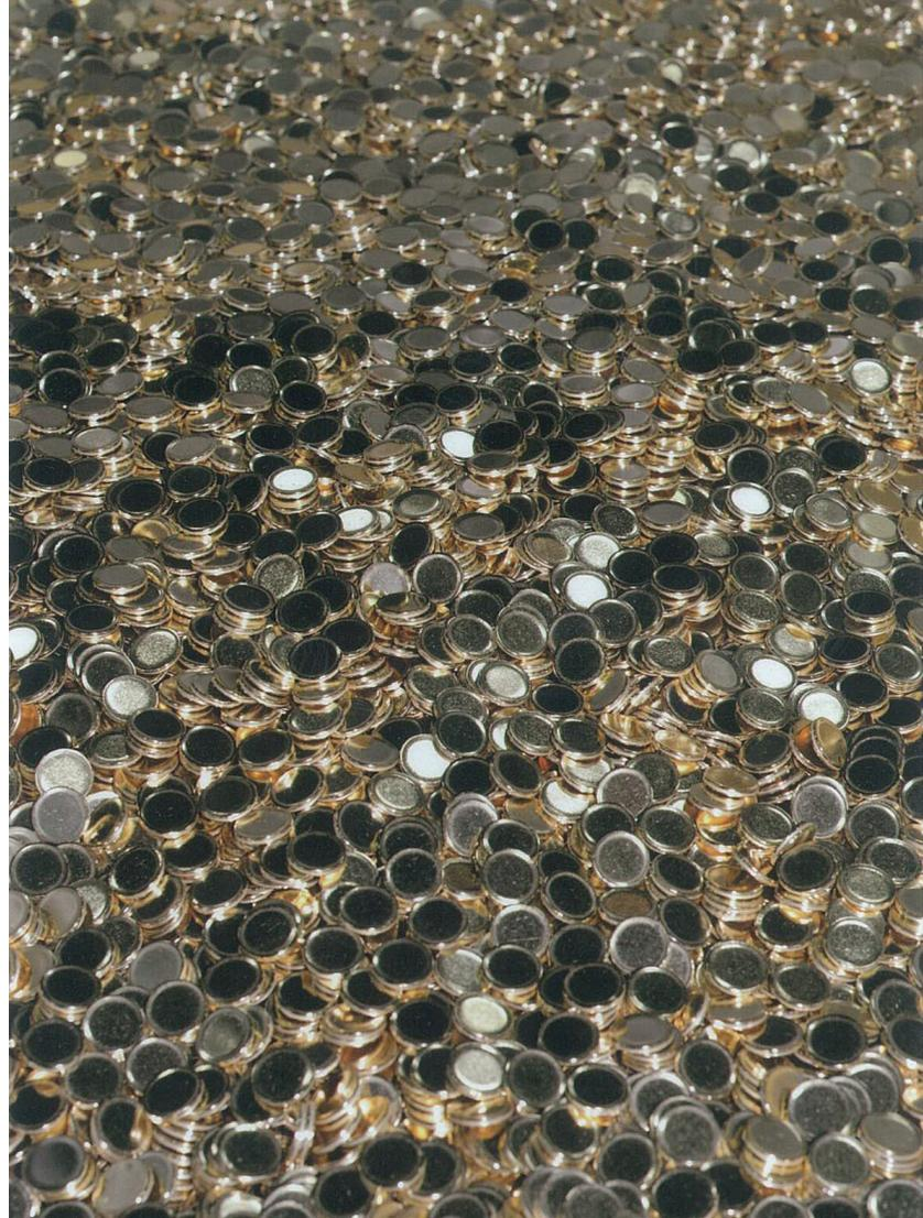
La lámina virgen es colocada en el carro cargador de la prensa de corte Schuler, con la finalidad de ser cortada y perforada. El resultado de este proceso, dependiendo de la herramienta de corte utilizada, es lo que denominamos "núcleo" o "arillo".
